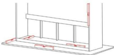
Das Wandbett sollte mit einer Wasserwaage richtig nivelliert werden – dies wirkt sich auf den Komfort, die Sicherheit bei der Nutzung und auf die Langlebigkeit des Möbels aus.
